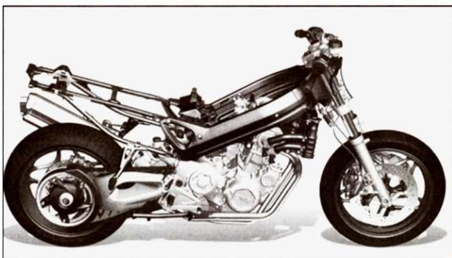
Sehr kompakt ist der flüssigkeitsgekühlte Twin geraten. Der Tank ist schwerpunktmäßig günstig platziert. (Foto: Werk)
