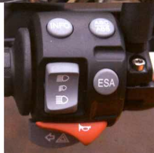
Zerklüftete Ansichten bietet das Motorgehäuse. Voll ausgestattet, da hat die linke Hand reichlich Gelegenheit, an den Knöpfen zu spielen. Das ABS ist abschaltbar und das ESA bringt Komfort. (Fotos: Lenzen)
