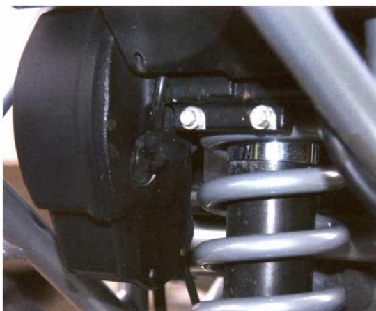
Elektrohydraulisch verstellbar ist das Federbein. Für jede Strecke lässt sich per Knopfdruck die richtige Einstellung finden.
