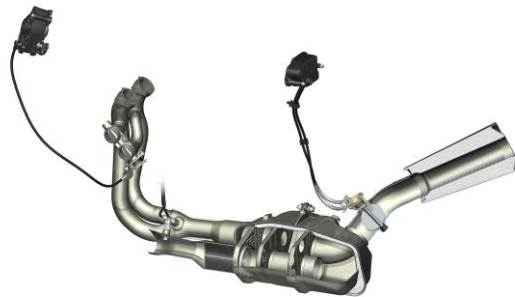
Schnittmodell der Auspuffanlage einer BMW S 1100RR mit Auspuffklappensteuerung. Bildquelle BMW
