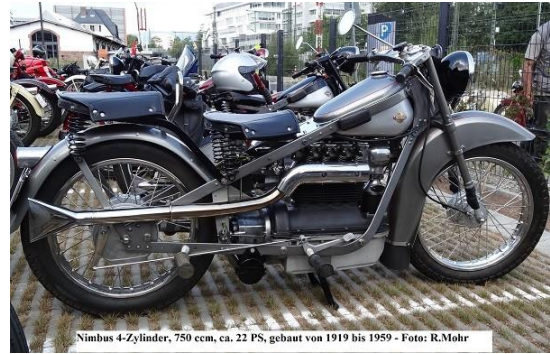
Nimbus 4-Zylinder, 750 ccm, ca. 22 PS, gebaut von 1919 bis 1959 - Foto: R.Mohr
